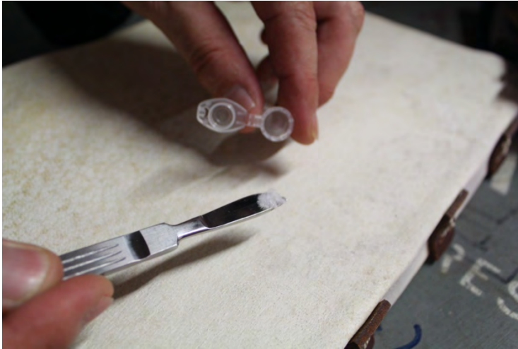
Slika 2. Uzimanje uzorka kristalizirane soli na površini pergamenske korice za analizu (foto: Dragica Krstić)
