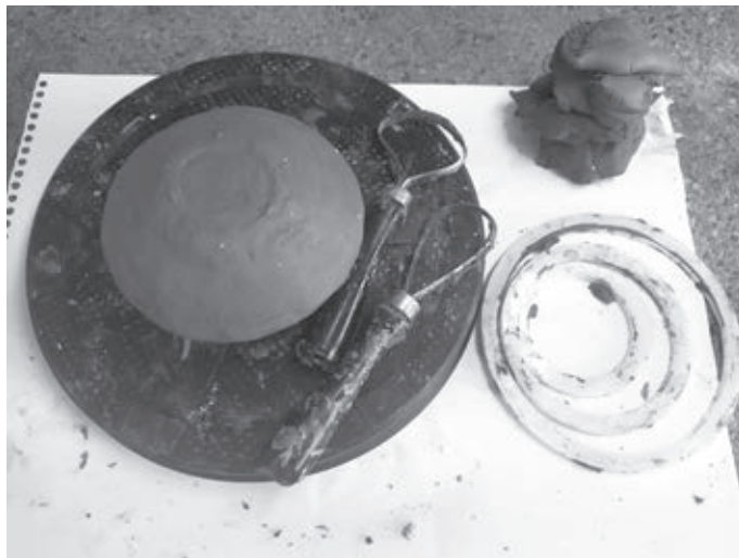
Slika 5. Izrada punoga unutarnjeg glinenog kalupa s alatima za obradu gline (snimila: Marina Gregl)
